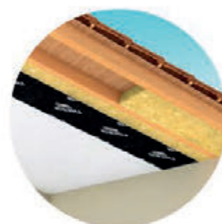
Copertura inclinata in latero-cemento, isolata in estradosso
