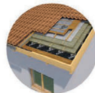
Copertura inclinata ventilata in legno, isolata in estradosso
