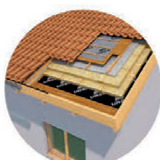
Riqualificazione di copertura piana, isolata in estradosso
