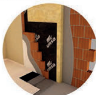
Pareti perimetrali in laterizio isolate in intercapedine
