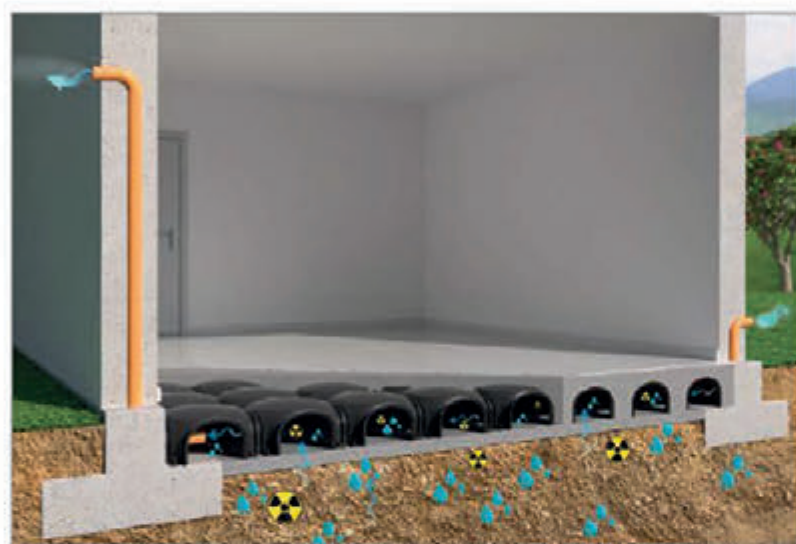
Abitazione costruita con una fondazione ventilata IGLU'®.
