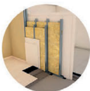
Pareti di separazione con sistema a secco
