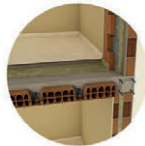
Pareti perimetrali con sistema a secco in ambito industriale
