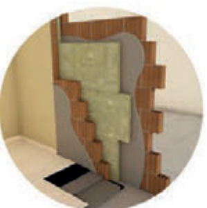
Pareti perimetrali in laterizio isolate dall'interno con controparete in lastre di gesso rivestito
