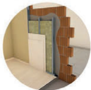
Pareti perimetrali in laterizio isolate
