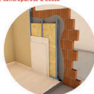
Pareti di separazione in laterizi forati e controparete a secco
