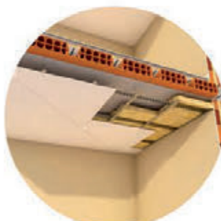
Copertura inclinata, isolamento in intradosso, sottotetto non abitabile
